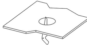
2. Verwenden Sie einen Schraubenzieher, um die Abdeckung der Treiberklemmen zu öffnen, führen Sie das AC-Hauptkabel L. N. in die Klemmenleiste ein und befestigen Sie dann die Abdeckung wieder.
