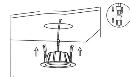
4. Stellen Sie sicher, dass das Downlight fest in der Decke befestigt ist, und schalten Sie die Stromversorgung ein.
