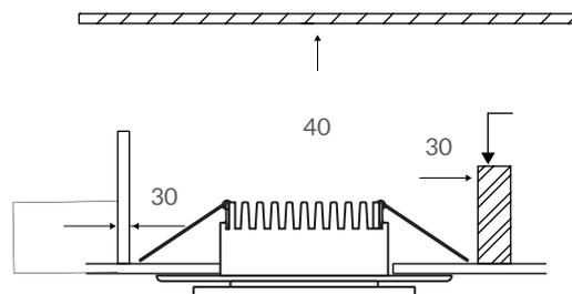
Die Downlights werden mit Schwertfedern ausgeliefert. Zusätzlich sind seitliche Federclips beige packt. Kabelanschluss steckbar oder auf Wunsch mit Kabelenden.
