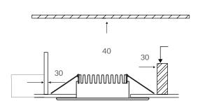
Die Downlights werden mit Schwertfedern ausgeliefert. Zusätzlich sind seitliche Federclips beigepackt. Kabelanschluss steckbar oder auf Wunsch mit Kabelenden.
