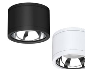
C3: 3000-4000-5700 K / CRI >80 / Abstrahlwinkel 75° / IP 65 / Netzteil On-Off inkl. / UGR <23 /
