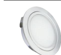
24 V / Leitung 50 mm / Verlängerung 2000 mm mit Lin24 Stecker / Abstrahlwinkel 120° / CRI >90 / IP 20 / Lin-Netzteil exkl. / Lebensdauer 25.000 h
