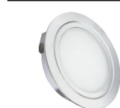
MM-Prüfzeichen / Direktanschluss 230 V / 2000 mm Leitung mit Lin230 Stecker / CRI >90 / IP 20 / Abstrahlwinkel 120° / Dimmbar ab 2 Leuchten (Mindestlast) / Lebensdauer 25.000 h
